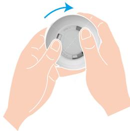
2. Entfernen Sie die isolierende Kunststoffummhüllung der Batterie und setzen Sie die Batterie entsprechend der Plus- und Minuspol-Kennzeichnung ein.
