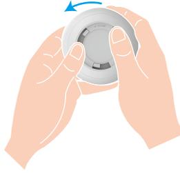
**i** Wenn die Batterie ausgetauscht werden muss, verwenden Sie bitte eine Li-Mn-Batterie des Typs CR14250.
